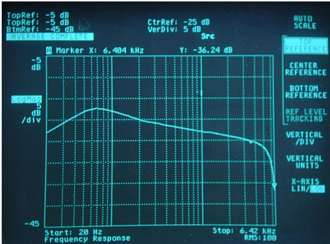
Kuva 17: Kuvassa on kalibrointilaitteiston taajuusvaste ilman siihen kiinnitettäviä testattavia värähtelyantureita. Taajuusvaste on kohtuullisen tasainen mittausalueella, joten se ei rajoita mittauksia.
