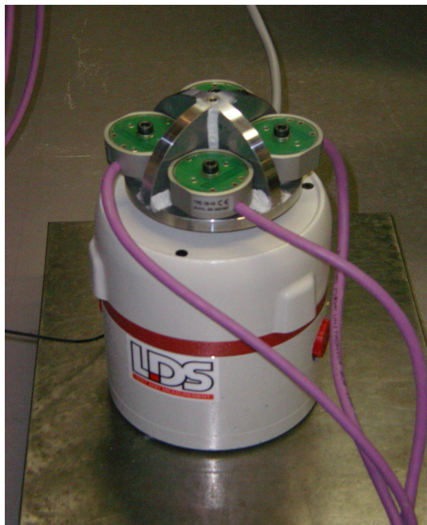
Kuva 15: Kalibrointilaitteiston tärustin, kalibrointiteline ja 4 kalibroitavaa anturia.
