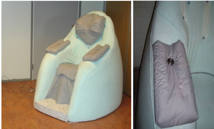
KUVA 12. TKK:lla rakennetussa BKG-tuolissa EKG-anturit on upotettu käsinojiin.
