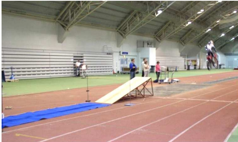
KUVA 4. Mittaustilanne. Nopeus mitattiin ennen hyppyä valokennoilla, tiedonkeruujärjestelmä oli alastulopaikan voimalevyn vieressä ja kamera taustalla kohtisuorasti alastulopaikkaan.
