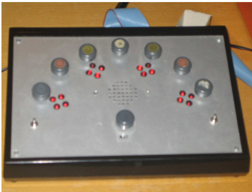
KUVA 3. Reaktioajan mittaamisessa käytetty laite.
