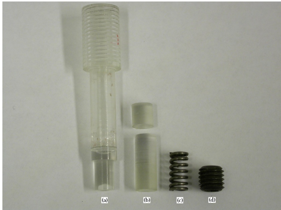
Kuva 7.2: Näytteenpidikkeen osat: (a) pidikkeen runko, (b) käytetyt vastinkappaleet, (c) puristuksessa käytetty jousi ja (d) puristinruuvi. Puristamiseen käytettyjen vastinkappaleiden halkaisija oli 7 mm. Puristettavaa pigmenttiä asetettiin vastinkappaleiden b väliin ja sen jälkeen kierrettiin ruuvia d jolloin jousi c puristaa näytettä. Puristusvoima voidaan määrittää kun tiedetään jousen jousivakio ja ruuvin nousu yhdellä kierroksella.
