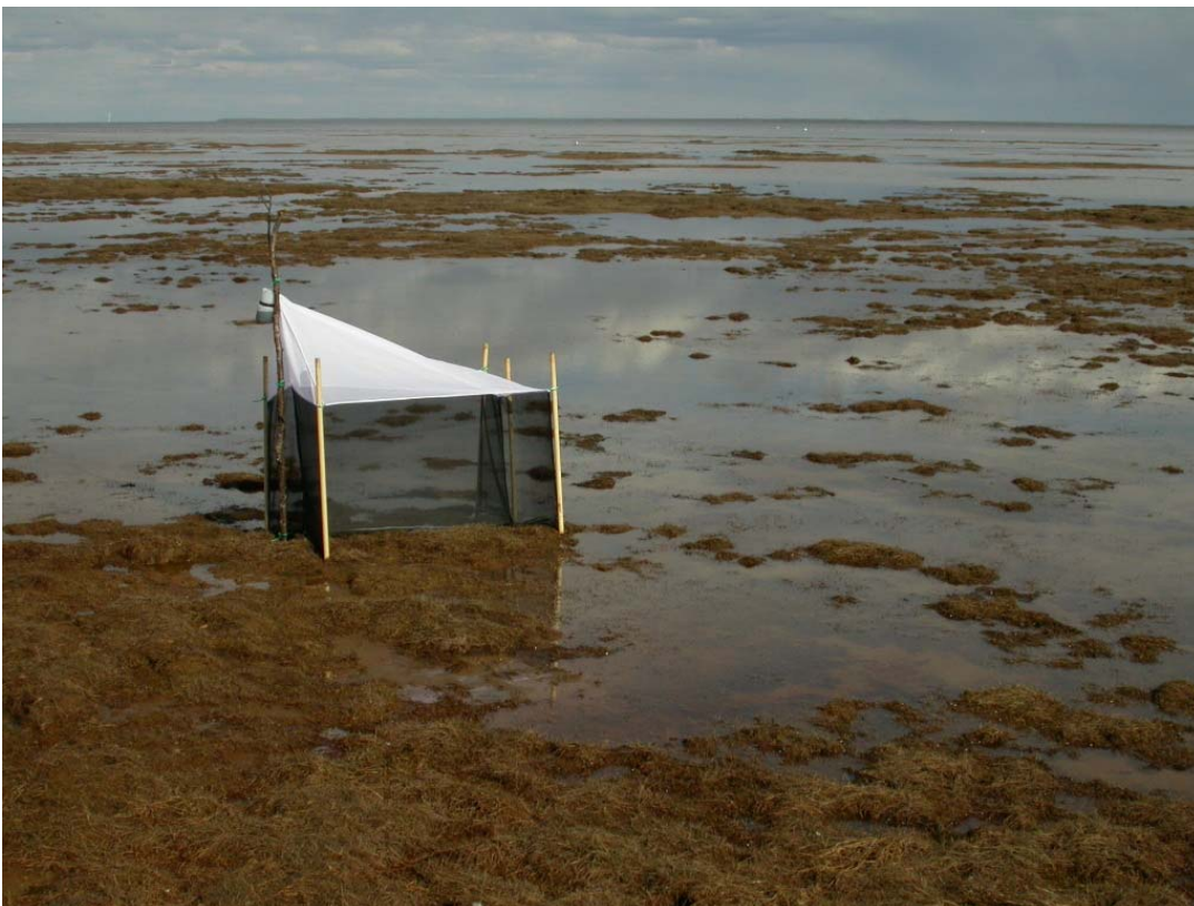
Kuva 4. Malaise-hyönteispyydys Hailuodon Tömpän merenrantaniityllä. Hyönteiset törmäävät lentäessään pyydiksen keski- tai päätykankaaseen ja lähtevät kiipeämään ylöspäin. Pyydiksen korkeimmassa kohdassa on keräysastia, johon hyönteiset lopulta päätyvät. Kuva: Teemu Nieminen 02.06.2005.
