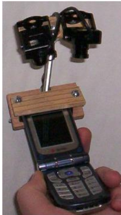
KUVA 3. Vaihdettava kiinnitysmekanismi mahdollistaa minikameroiden kiinnittämisen erilaisiin mobiililaitteisiin. Kameran kuvaavat mobiililaitteen näyttöä ja näppäimistöä. Kolmas kamera voidaan kiinnittää kuvaamaan koehenkilön kasvoniilmeitä. (Schusteritsch ym. 2007).
