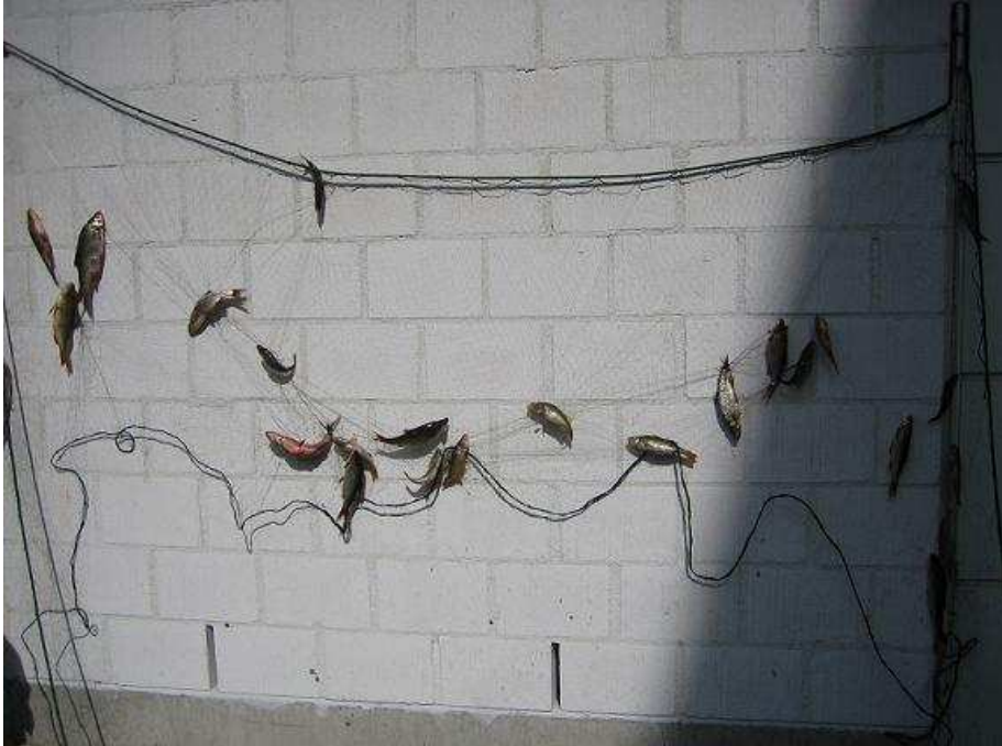
Kuva 16. 25 mm paneelin tarttuneita kaloja (enimmäkseen särkiä). Kalojen kerääntyminen verkkoon on aiheuttanut verkon huomattavaa kasautumista ja kiristymistä, jolloin verkon alkuperäinen pyyntipinta-ala on pienentynyt selvästi (vrt. kuva 15).
