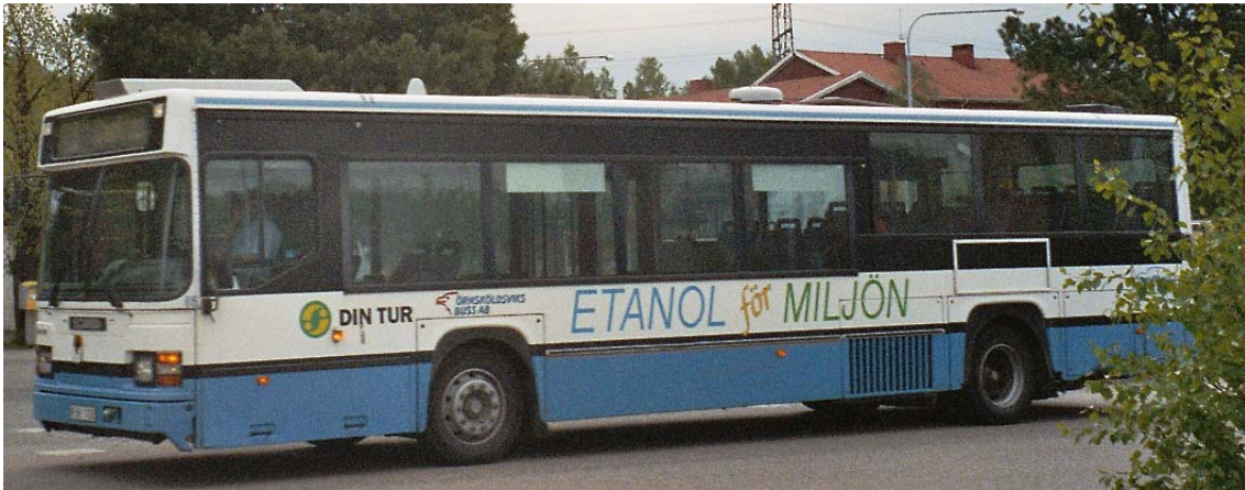
Kuva 5.4. Paikallisesti puusta (hakkeesta ja sulfiittilipeästä) 2 eri teknologialla valmistettua etanolia käyttävä kaupunkibussi Örnsköldsvikissa Ruotsissa. [2005]
