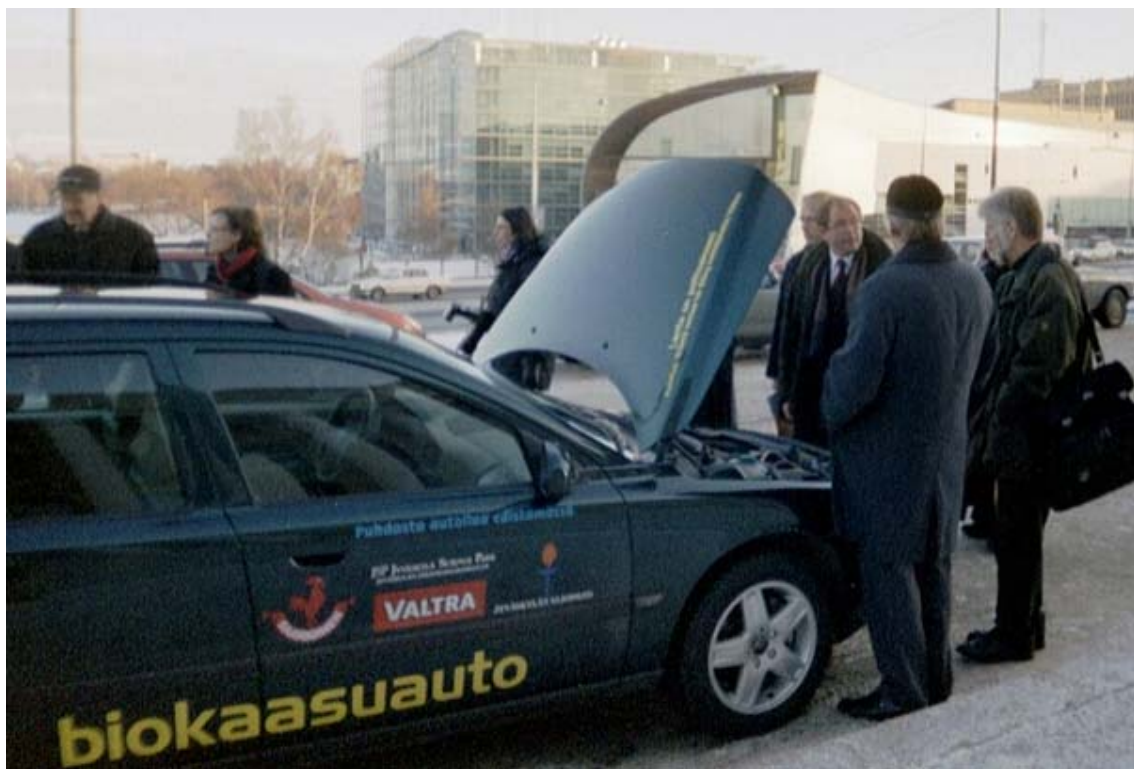
Kuva 3.2. Kansanedustajat tutustumassa Suomen ainoaan (edelleen ainoa keväällä 2006) biokaasukäyttöiseen ajoneuvoon, Erkki Kalmarin Volvo V70 Bi-fueliin joulukuussa 2002. Bi-fuel-malli pystyy käyttämään sekä metaania (tässä CBG100, mutta myös CNG100) että bensiiniä. Biokaasu tuotetaan maatilareaktorilla Laukaassa (Kuva 7.8). (Lampinen 2004b) [2002]
