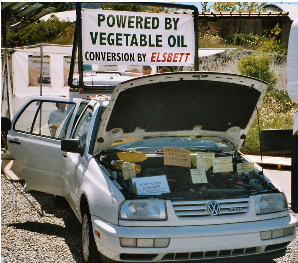
Kuva 5.5. Kasviöljyjen (PPO100) käyttöön pystyvä dieselauto, johon on asennettu saksalainen Elsbett-konversiosarja. Moottoriin on merkitty lapuilla noin 10 osaa, jotka konversiossa on lisätty tai vaihdettu. Konversiosarjan hinta kuvan VW Jettaan on noin 800 €. Konversiosarjoja on saatavissa myös maatalouskoneisiin. Konversion jälkeen jää mahdollisuus käyttää myös fossiili- ja biodieseliä. [2004]
