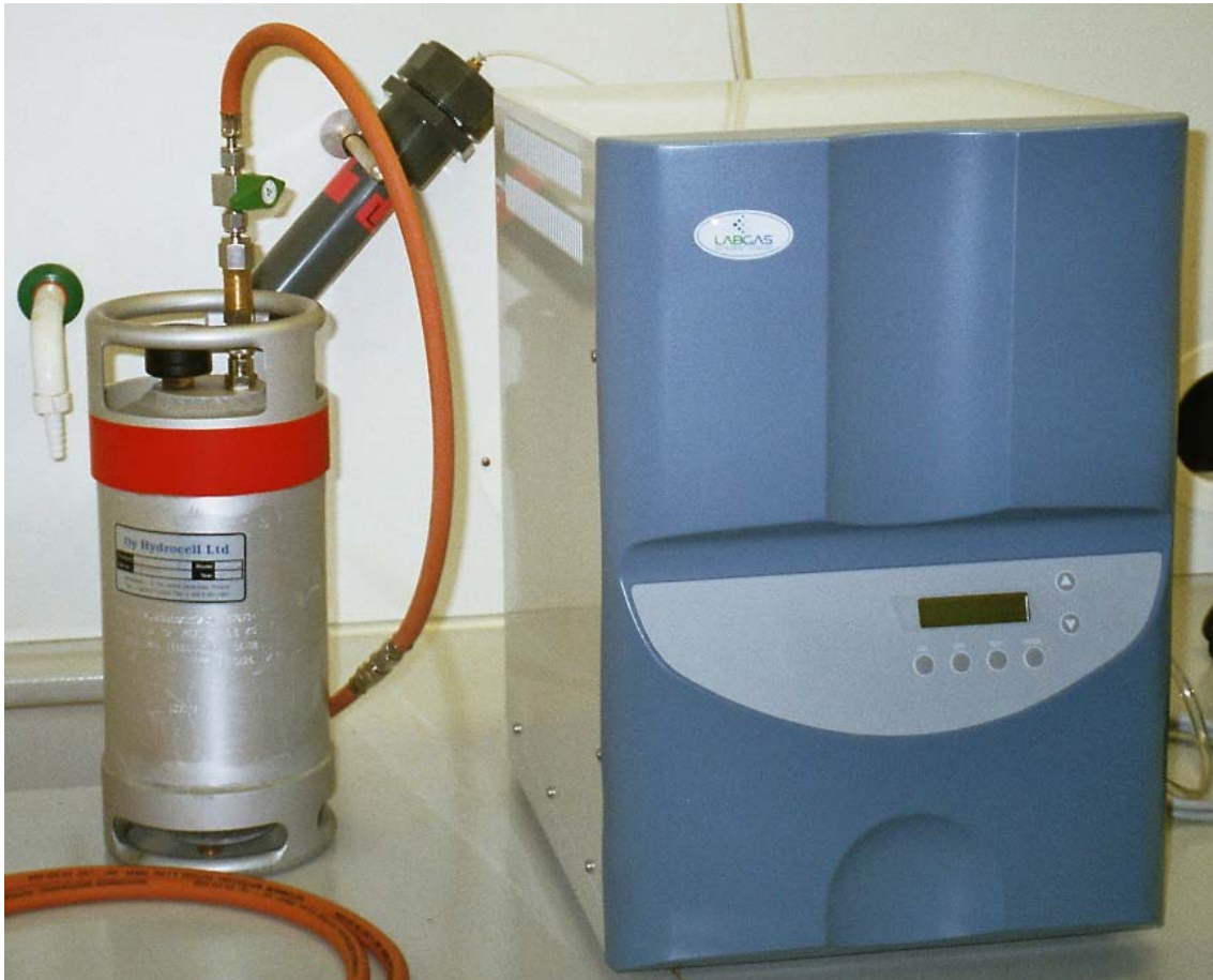
Kuva 2.15. Kotimainen maatilakokoluokan elektrolyyserilaitteisto vedyn valmistamiseksi vedestä (oikealla) sekä kotimainen vedyn varastointisäiliö (vasemmalla). Tällä laitteistolla valmistetaan tuuli- ja aurinkosähköllä vetyä liikennekäyttöön Jyväskylän yliopistossa. [2005]
