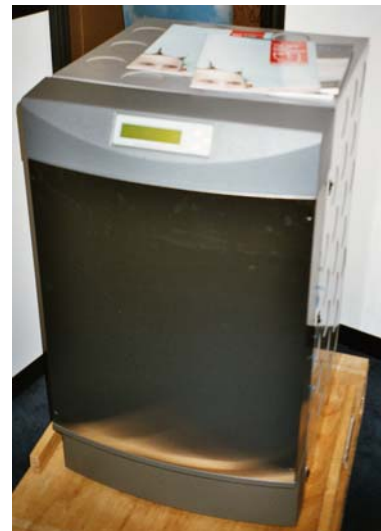
Kuva 5.2. Omakotitalo- ja maatilakokoluokkiin CHP-käyttöön valmistettava uusiseelantilainen stirlingmoottori. [2006]
