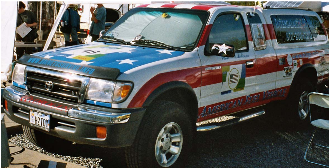
Kuva 6.9. Toyotan maasturista kaupallisella jälkiasennussarjalla muokattu erittäin polttoainejoustava malli esittelyssä maaseudun uusiutuvan energian messutapahtumassa Kaliforniassa. Se pystyy käyttämään bensiiniä, etanolia ja metanolia puhtaina tai niiden minä tahansa seoksina sekä metaania ja vetyä puhtaina tai niiden minä tahansa seoksina (hytaani). Siinä on erilliset tankit kaasumaisille ja nestemäisille polttoaineille. [2004]
