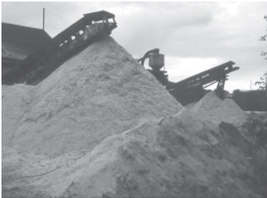
Ketjukuljettimet siirtävät jätteen muhakasoihin ja laudan päät tehdään hakkeeksi.
