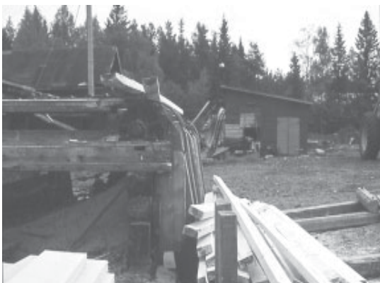
Lajittelupöydältä osa laudoista tippuu suoraan kasaan, osa viedään vaunuille, laadun ja koon mukaisiin nippuihin.
