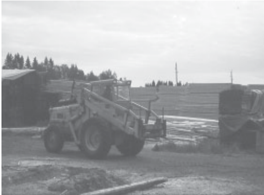
Lautahaarukalla varustettu trukki siirtää laudat pinoihin.
