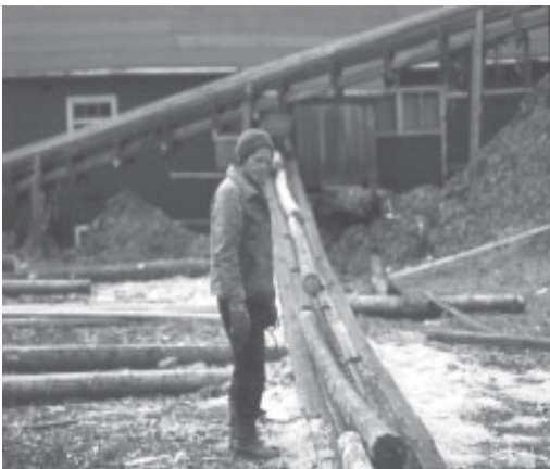
Repsikka siirtää tukit kuljetusketjulle. Työssä tarvitaan oikeaa nostotekniikkaa.
