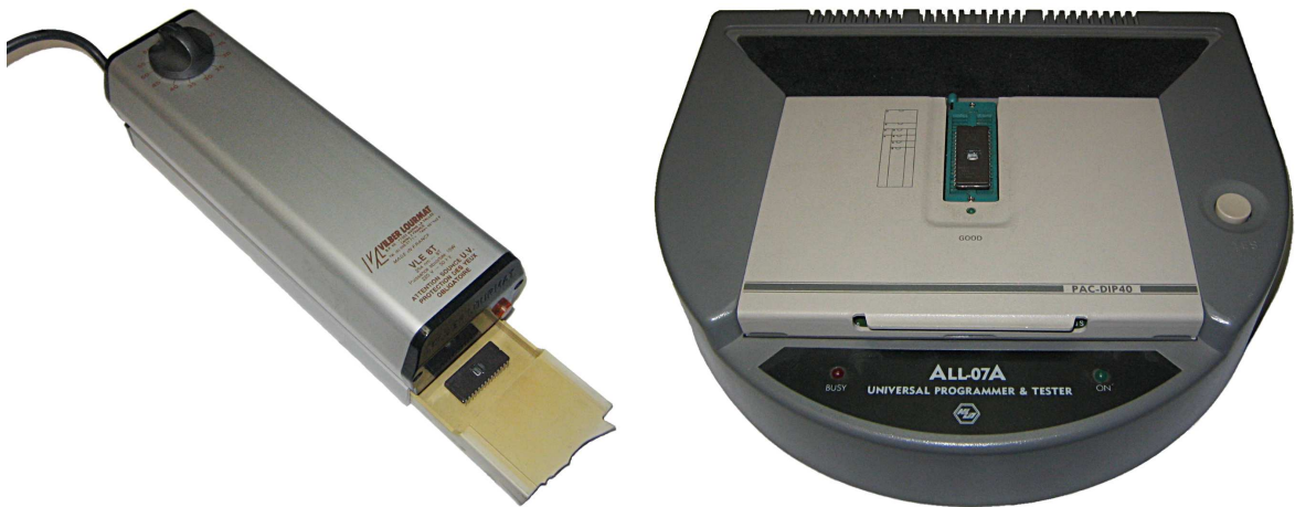
Kuva 3.2: Vasemmalla EPROM-muistin tyhjennyslaite ja oikealla ohjelmointilaite. Kuvan 3.1 piiri on asetettu kumpaankin laitteeseen.
