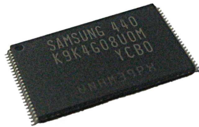
Kuva 3.8: K9K4G08U0M-tyyppinen NAND flash -piiri. Piirin suurin leveys on noin 20 millimetriä.
