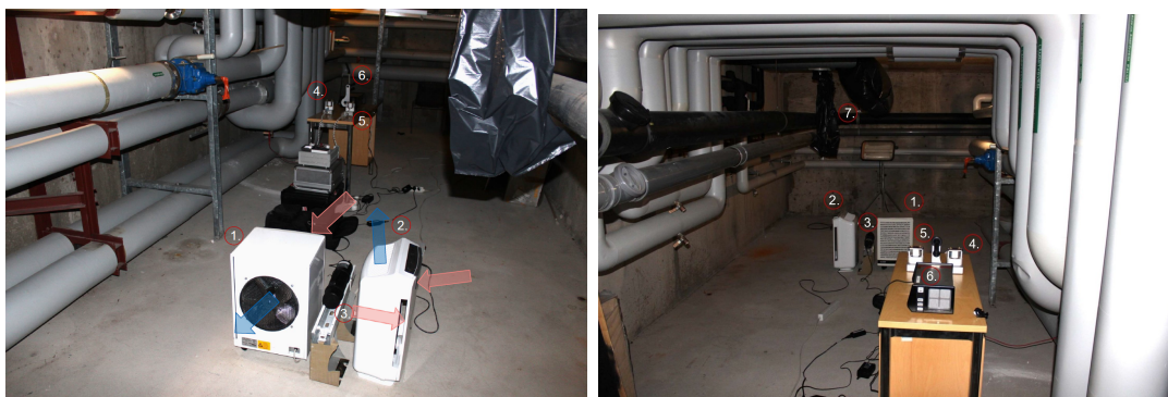
Kuva 8. Rakennettu koeasetelma eri kuvakulmista. Koeasetelmaan kuului 1. Elixair E400-ilmanpuhdistin 2. Electrolux EAP300-ilmanpuhdistin 3. LaBr 3 -gamma-spektrometri 4. Tracerlab BWLM-PLUS-2S-ilmaisimen kiinnittymättömien hajoamistuotteiden kerääjä 5. Tracerlab BWLM-PLUS-2S-ilmaisimen kiinnittyneiden ja kiinnittymättömien hajoamistuotteiden kerääjä 6. AlphaGUARD P30-radonmittari. Oikeanpuoleisessa kuvassa on merkitty 7. suljettu ilmanvaihto. Vasemmanpuoleiseen kuvaan on merkitty ilmavirtauksen suunta ilmanpuhdistimissa, punainen nuoli vastaa puhdistajan keräämää ilmaa ja sininen nuoli ulospuhallettavaa puhdistettua ilmaa.
