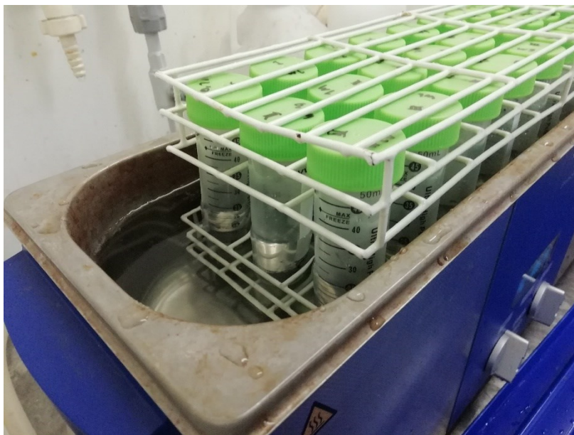
Kuva 16. Komponenttiliuotus suoritettiin suljetuissa 50 ml:n sentrifugiputkissa ultraääniavusteisesti.
