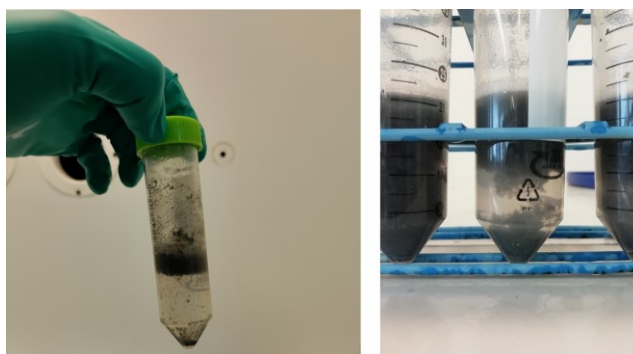
Kuva 17. Komponenttiliuotuksen jälkeisen boorihappokäsittelyn aikana seos vaahtosi ja kiintoaine nousi seoksen pinnalle.
