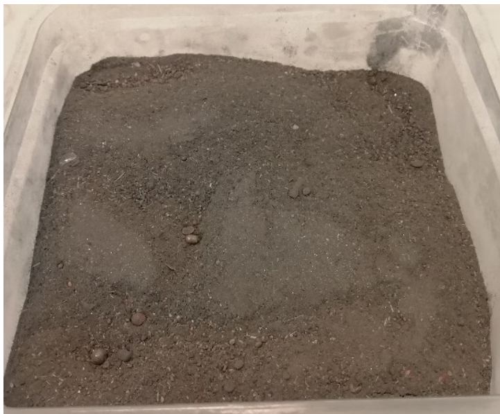
Kuva 15. Näyttemateriaalina käytetty hienonnettu komponenttimateriaali.
