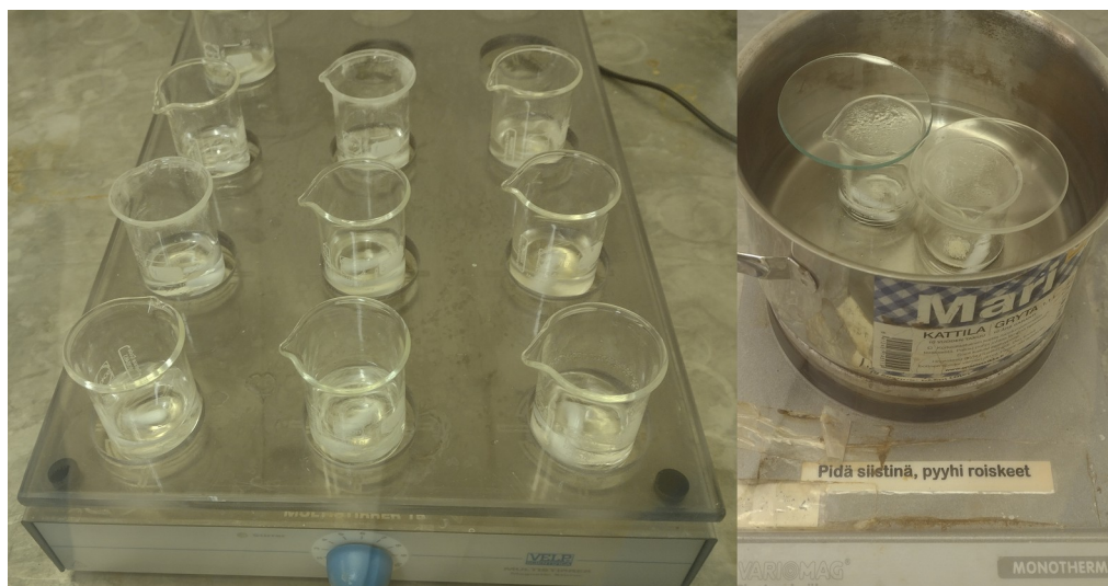
Kuva 12. Normaalikokeiden magneettisekoitus ja lämpötilakokeen magneettisekoitin ja kattila.
