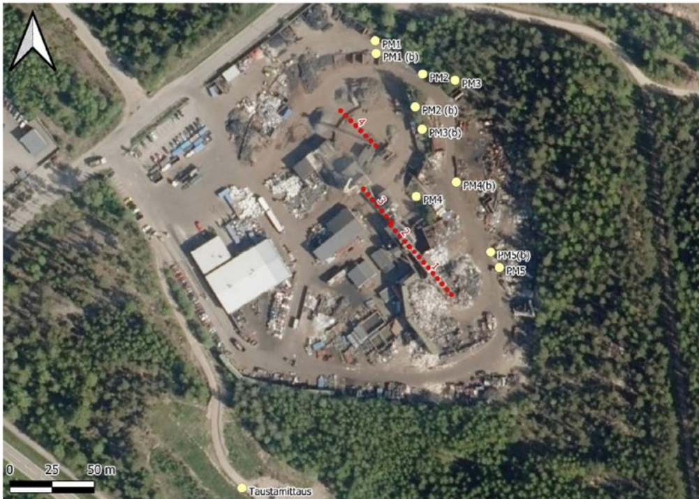
Kuva 3. Hajapölypäästömittauksen näytteenottopisteet murskauslaitoksen koillisosassa. Näytteenottopisteet on kuvattu keltaisilla pisteillä sekä hajapäästökertoimien määrittämisessä käytetyt päästölähteet punaisina pisteviivoina. ©Envineer Oy
