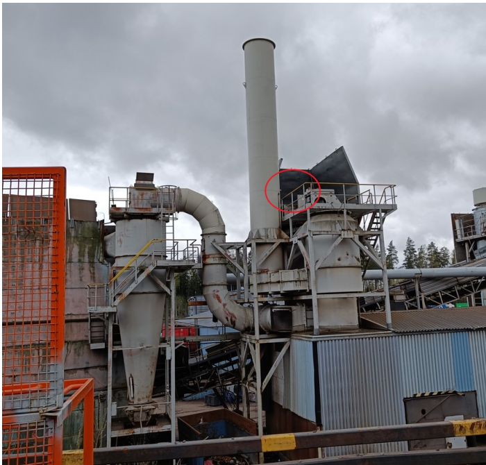
Kuva 2. Päästöinventaarioriomittausten mittauskohde pesurin päällä olevasta poistoilmaputkesta. ©Eveliina Kyllönen
