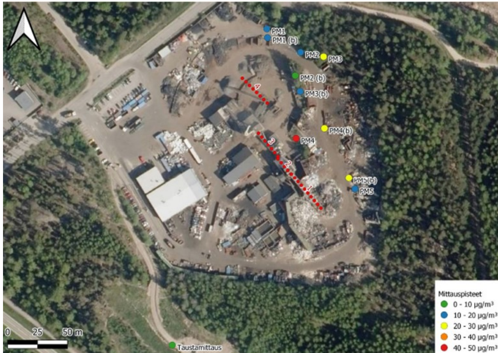
Kuva 5. Mittauspisteet ja niiden hiukkasmittausten tulokset pitoisuusluokittain. Punaiset pisteiviivat kuvaavat hajapäästöjen lähteitä. ©Envineer Oy
