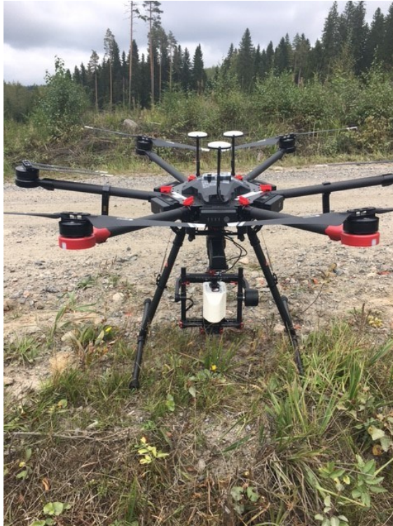
Kuva 3. DJI Matrice 600 Pro -kopteri, jonka kyydissä on hyperspektrikamera sekä säteilyvoimakkuus- ja GPS-mittarit. Kuva otettiin ensimmäisessä lennätyspaikassa Taka-Keljossa Jyväskylässä.
