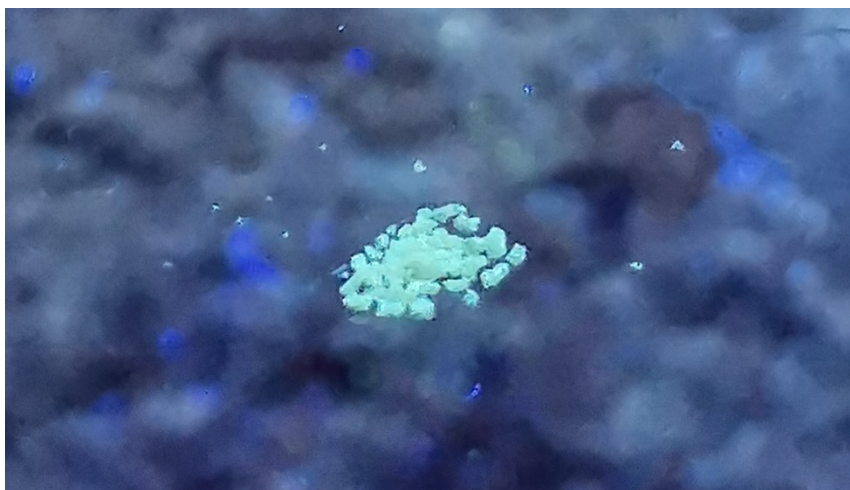
Kuva 46. Tuotteen 3 kiteiden fluoresenssia viritettäessä niitä 366 nm:n UV-valolla.
