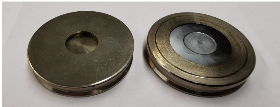
Kuva 25. PXRD-mittauksissa käytetyt näytepidikkeet. Vasemmalla teräksinen 16 mm kuoppalevy, ja oikealla yksikidepiistä valmistettu nollataustalevy.
