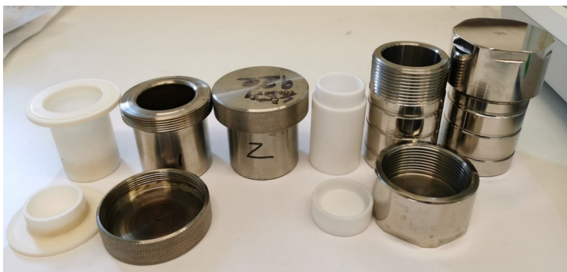
Kuva 19. Synteeseissä käytetyt teräskuoriset teflonreaktorit. Vasemmalla 25 ml reaktorin teflonsisuus, teräskuori sekä kasattu reaktori, oikealla 22 ml reaktorin teflonsisuus, teräskuori sekä kasattu reaktori.
