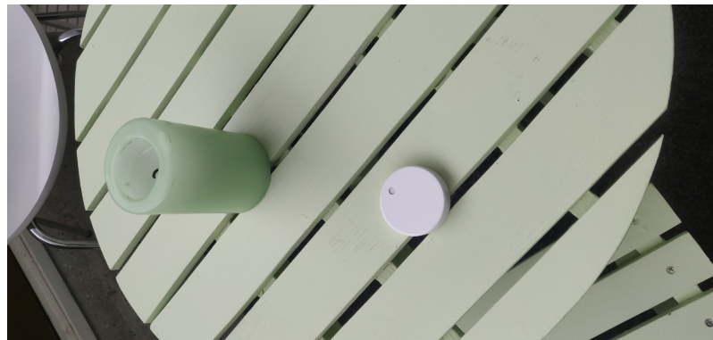
Kuvio 6. Parvekkeen pöydällä oleva RuuviTag sensori, joka mittaa ilmanlämpötilaa ja ilmankosteutta.
