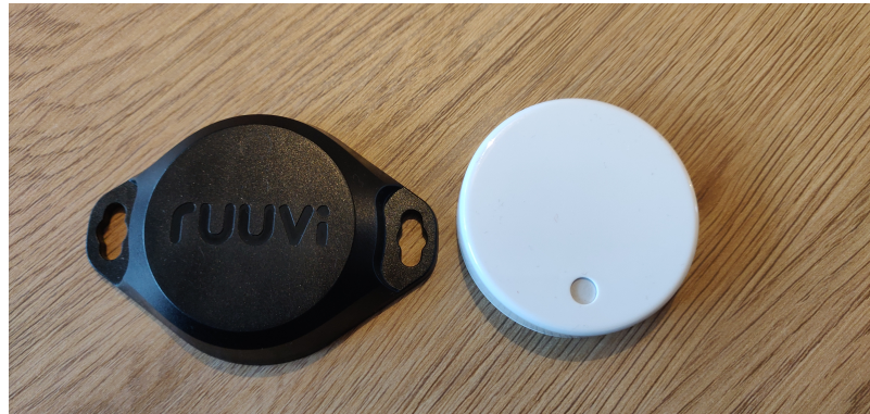
Kuvio 3. RuuviTag Pro ja RuuviTag sensorit, vasemmalla liikettä ja lämpötilaa mittaava sensori, oikealla lämpötilaa, ilmankosteutta, ilmanpainetta ja liikettä mittaava sensorii.
