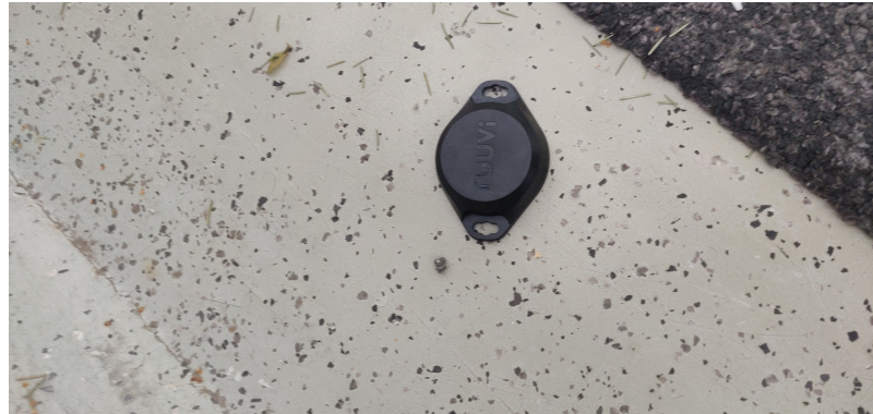
Kuvio 7. Parvekkeen lattialla oleva RuuviTag Pro sensori, joka mittaa lämpötilaa lattian tasolla.
