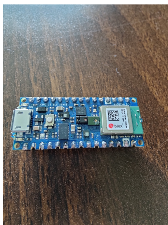
Kuvio 2. Arduino Nano 33 BLE Sense
