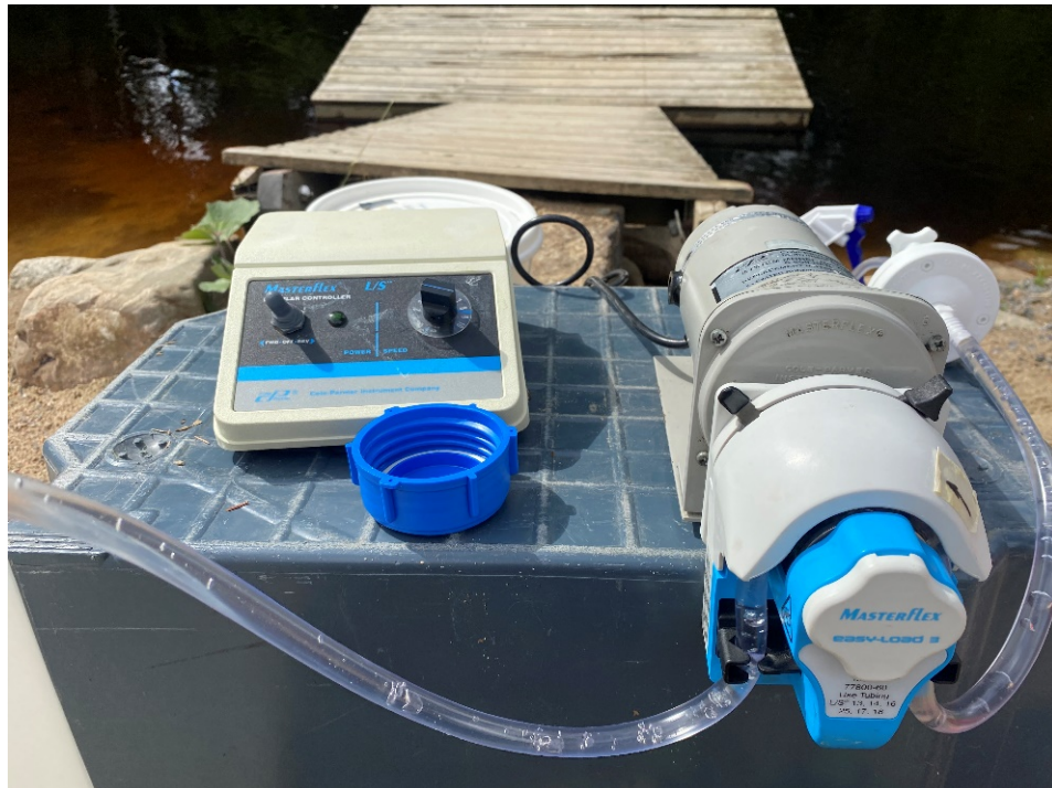
Kuva 5. eDNA-näytteenoton pumppujärjestelmä (Masterflex L/S Easy-Load 3 77800-60 & Modular controller). Kuva Emmi Ventelä.
