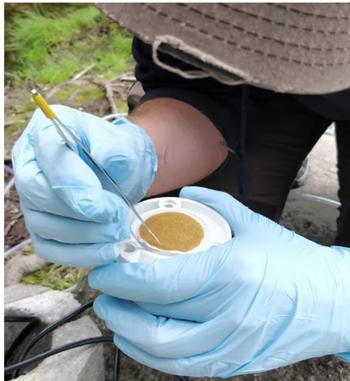
Kuva 9. Valmis suodatin poistetaan varovasti pinsettien avulla. Kuva Timo Ruokonen.
