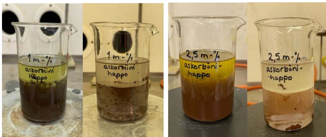
Kuvat 35 ja 36. Kullan pelkistyminen 1 m-% askorbiinihapolla heti lisäyksen jälkeen sekä 15 minuutin kuluttua lisäyksestä. Samat tilanteet vastaavasti 2,5 m-% askorbiinihapolla.
