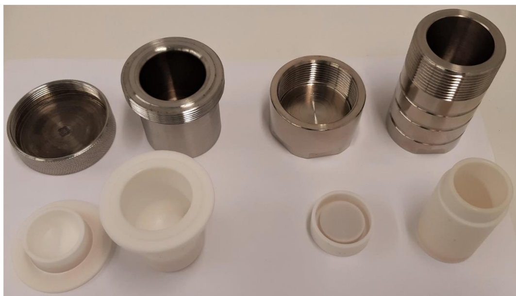
Kuva 18: Solvotermisissä synteeseissä käytetyt autoklaavireaktorit ja tefloniset sisäastiat.
