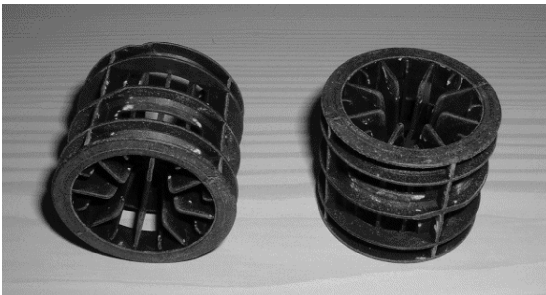
Kuva 4: Biofilmin kasvualustana oli kantajakappaleita. Kappaleen korkeus on 35 mm ja halkaisija 43 mm.
