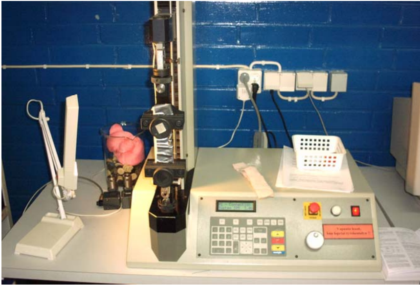
Kuva 23. Vetokone toiminnassa. Testattavana materiaalina idealside + teippi
