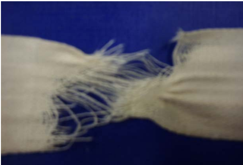
Kuva 28. Kangasside voima – venymäkokeen jälkeen
