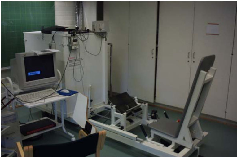
Kuva 21. Isometrisen voiman mittauksessa käytetty penkki Jyväskylän yliopiston liikunta-biologian laitoksella
