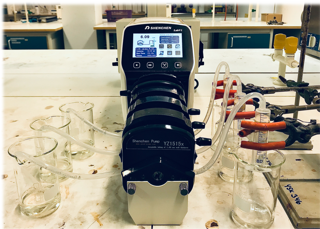
Kuva 18. Koeasetelma kinetiikan vaikutuksen tutkimisesta metallien talteenotossa.
