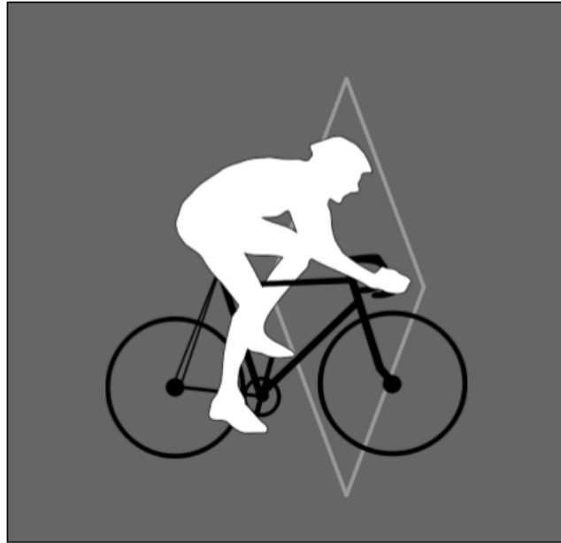
Kuvio 4. Polkupyöräilijöiden laskemiseen tarkoitettu induktiosilmukka.
