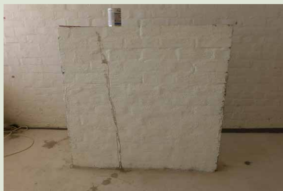
Muuraus- ja slammausmalli, jossa on kahdenlaista muuraustapaa erilaisilla saumoilla.
