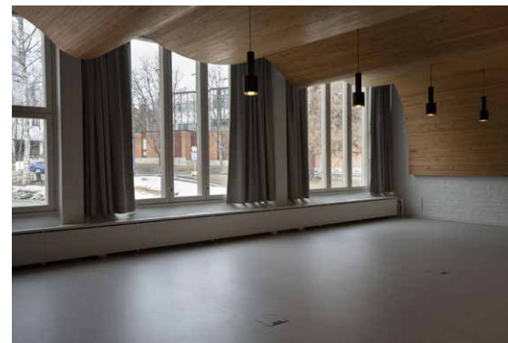
Akustiikkalasisit vaimentavat ulkoa tulevaa liikenteen melua. Ikkunan edessä akustoivat pimennysverhot.
