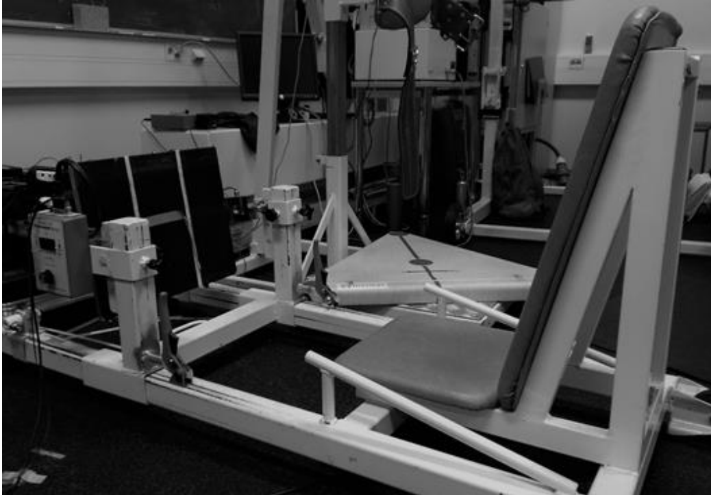
KUVA 8. Alaraajojen isometrisen maksimivoiman mittaamiseen käytetty laite (Seppänen, 2018)
