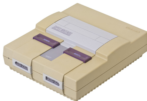
Kuvio 3. Ajan myötä värjäytynyt SNES-konsoli. Kuva: Evan Amos ( Public domain )
