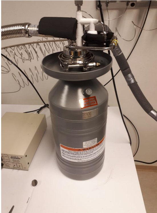
Kuva 15. Dewar astia, jossa nestetyypellä jäädytetään moduloinnissa käytettävää typpivirtaa.
