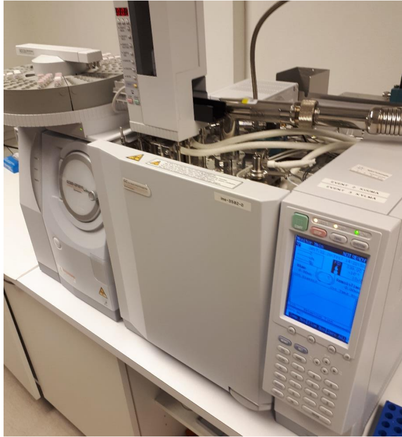
Kuva 14. Työssä käytetty kaasukromatografi. Kuvassa vasemmalla on qMS ja autosampler. Keskellä uunin päällä sijaitsee injektori, modulointitypen tuontiputki ja FID.
