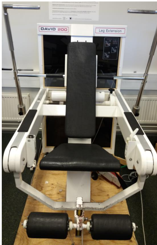
KUVA 7. DAVID 200-laite, jolla suoritettiin isometrinen polven ojennus, polven koukistus sekä penkkipunnerrus.
