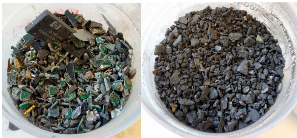
Kuva 14: Piirilevymurska ennen tuhkistusta ja tuhkistuksen jälkeen.
