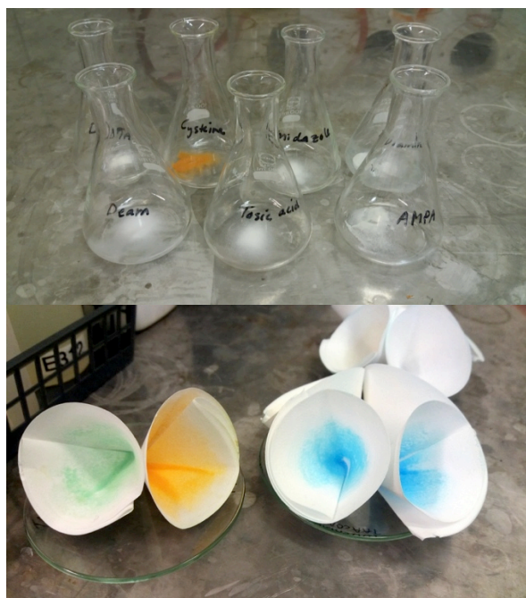
Kuva 26: SiliaMetS-metallisieppareita ennen käsittelyä rikkihappoliuoksella ja liuoksen suodattamisen jälkeen, jolloin metallisiepparit ovat sitoneet metalleja ja muuttaneet väriään.
