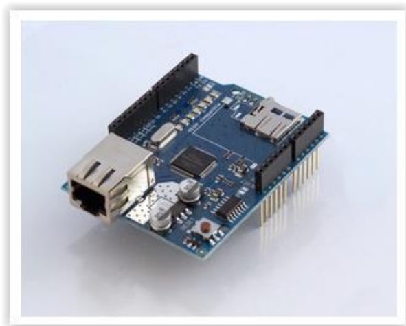
Kuva 3.13. Arduinon liitettävä Ethernet-kortti [36]
