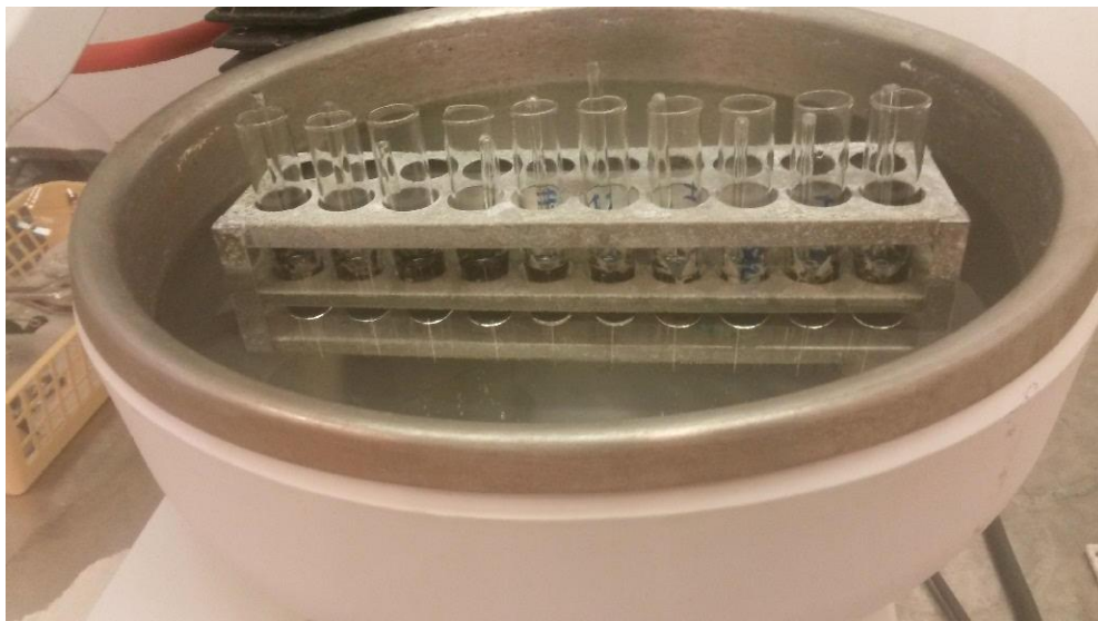
Kuva 13. Happohydrolyysi käynnissä koeputkissa 31 \text{ }^\circ\text{C} vesihauteessa.
