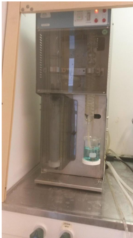
Kuva 17. Kjeldahlin laitteiston Pronitro I -laite neutraloi ja vesihöyrytislää näytteen.
