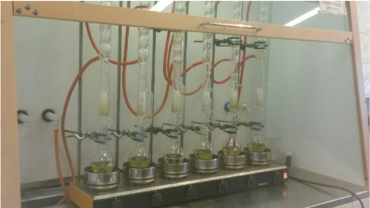
Kuva12. Lantanäytteiden heksaaniuutto Soxhlet -uuttolaitteella.
