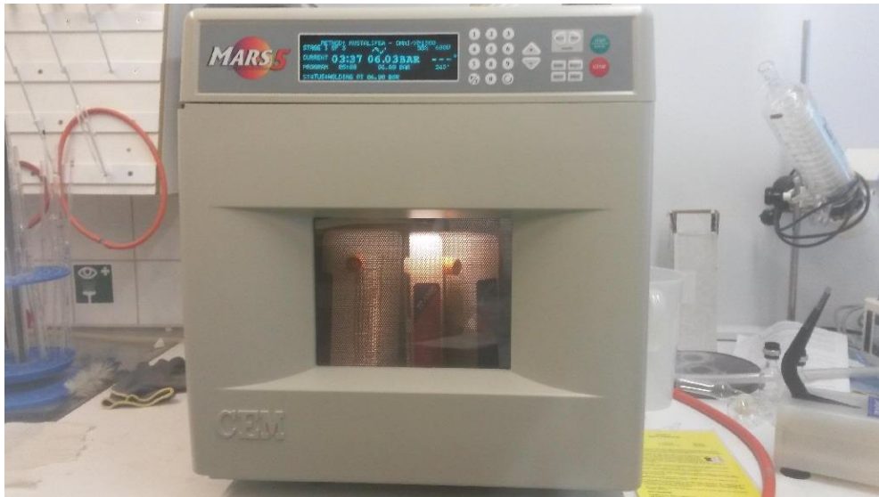
Kuva 18. Tuhkanäytteiden mikroaaltouuniavusteinen hajotus, Mars 5 mikroaaltouunissa.
