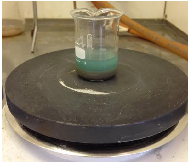
Kuva 29: Tuhkistetun piirilevymurskan typpihappoliuotus magneettisekoituksella.
