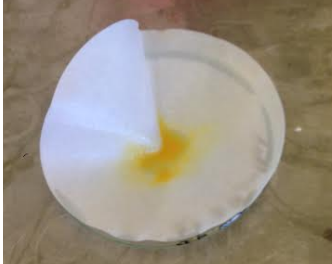
Kuva 30: Suodatetut Smopex ® -112v -kuidut kahden tunnin 6 M typpihappoliuoskäsittelyn jälkeen. Kuitujen havaitaan muuttaneen värinsä keltaiseksi alkuperäisestä vaaleanharmaasta.
