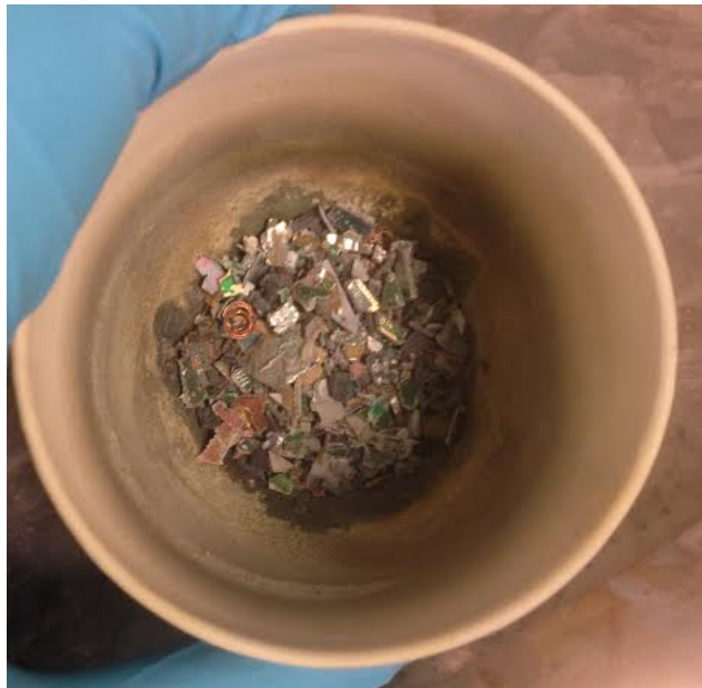
Kuva 28: Näytepussin C piirilevymurskaa posliiniupokkaassa.
