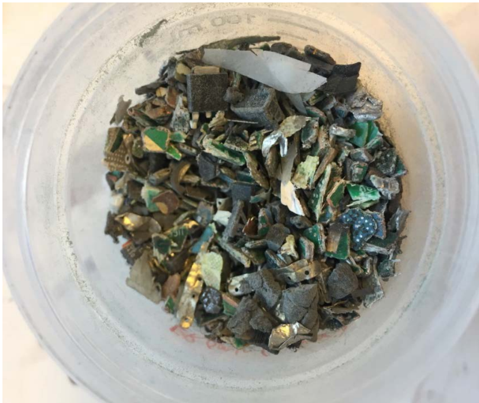
Kuva 13. Näytepussin C murskattua piirilevymateriaalia ennen termistä käsittelyä.
