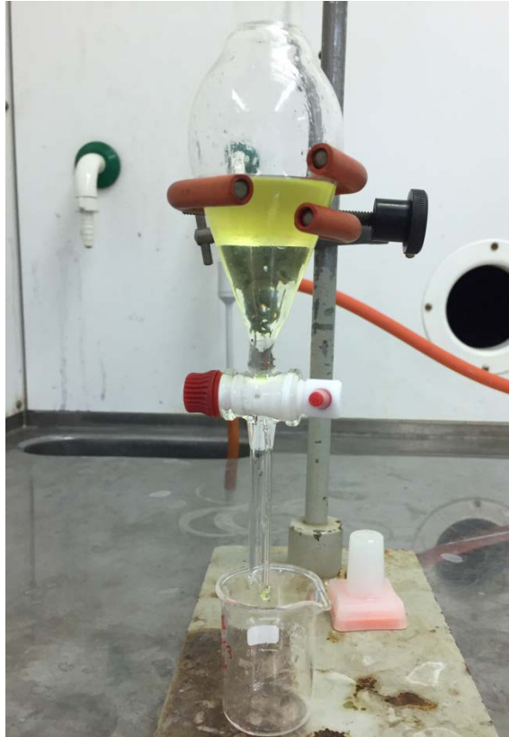
Kuva 2. Faasien erottuminen neste/nesteuutoissa kullan talteenotossa
