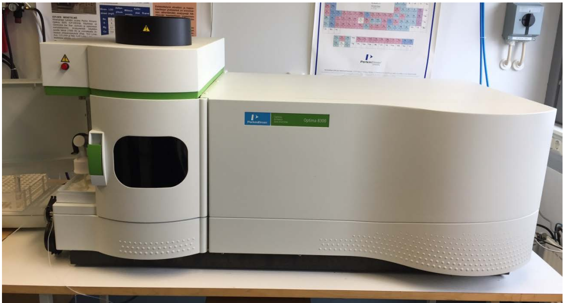
Kuva 8. PerkinElmer Optima 8300 ICP-OES-laitteisto.
