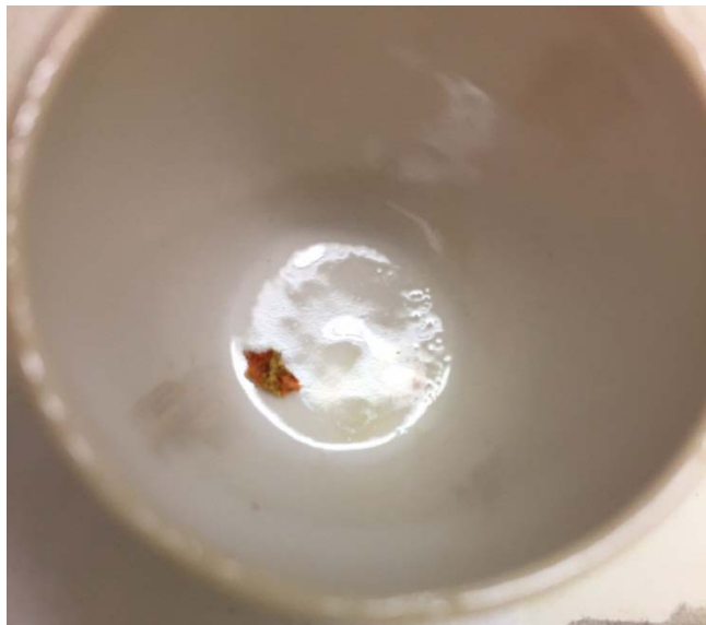
Kuva 17. Pelkistetty kultaa suodatinpaperin hiiltämisen ja termisen käsittelyn jälkeen.
