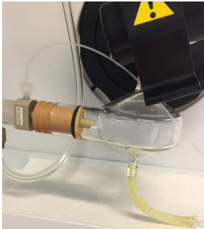
Kuva 9. GemCone-sumutin ja sykloninen sumutinkammio kytkettynä ICP-OES laitteistoon.
