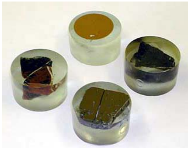
Kuva 10: Kivinäytteiden mikroanalyyssissä käytetään mikroskooppisen hienoksi kiilloitettua näytettä joka valmistetaan epoksiin. Myös jauhenäytteistä voidaan valmistaa samantyyppinen näyte. 58
