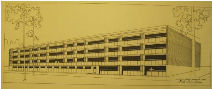
Rasikatu 1 (1966). Hämmäläisen suunnitteleman elementtitalon parvekenauhojen kaidemateriaalina on valkea Minerit-levy. Huoneistojen välinen pilari on päällystetty tammisäleiköllä. (JyMa)
