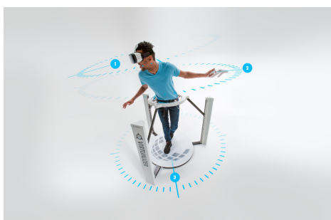
Kuva 2: Cyberithin Virtualizer kävelyalusta. Virtualizer mahdollistaa kolmen asteen erotellun liikkumisen: 1. katseen suunta, 2. manipulaatiosuunta, 3. etenemissuunta. Kuva on ladattu osoitteesta: http://cyberith.com/press/
