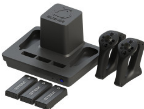
Kuva 3: Sixensen STEM kontrollit, kolme paikannusyksikköä ja magneettikentän tuottava lähetinyksikkö. Kuva on ladattu Sixensen verkkokaupasta osoitteesta: http://store.sixense.com/collections/stem
