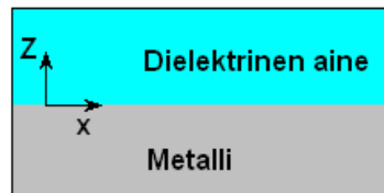
KUVA 2. Metallin ja dielektrisen aineen rajapinta, jossa SPP etenee.
