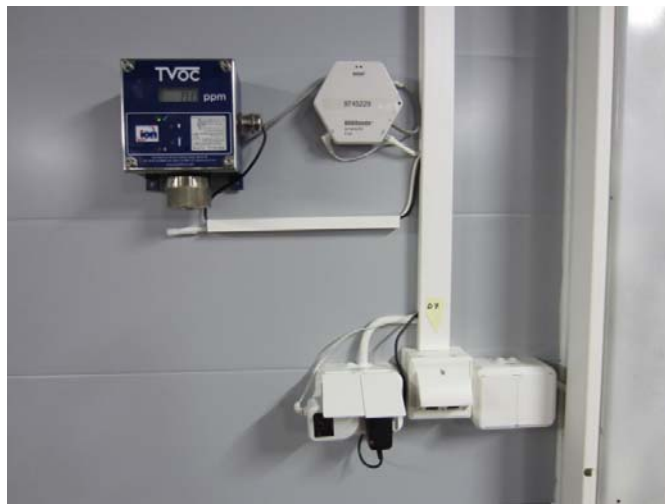
Kuva 5.13. Dataloggeri – ja VOC – mittausjärjestelmä. Valokuva Arja Koskinen 2013, Tampereen museot.
