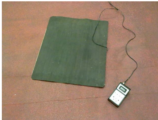
KUVA 3. Tutkimuksessa käytetty kontaktimatto ja lentoajan mittaamiseen käytetty kello, Liikuntabiologian laitos, Jyväskylän yliopisto.
