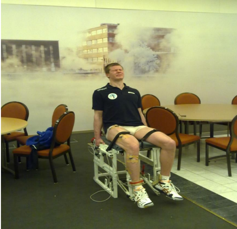
KUVA 20. Polvenojennuslaitteella mitattiin vastus lateral ja rectus femoris lihasten maksimaaliset isometriset EMG – arvot. Polvikulma oli 107°.
