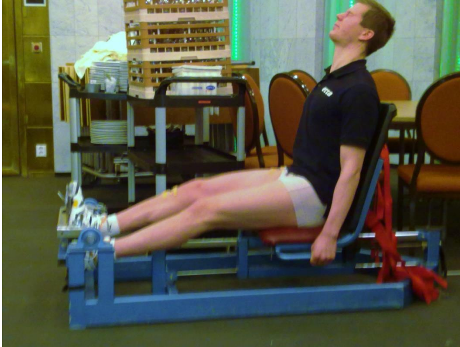
KUVA 19. Nilkan ojennus - ja koukistuslaite, jolla tehtiin maksimaaliset isometriset mittaukset soleus ja tibial anterior lihaksille.
