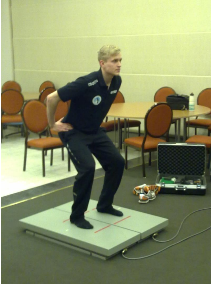
Kuvassa 18 kaksi voimalevyä vierekkäin molemmille jaloille.
