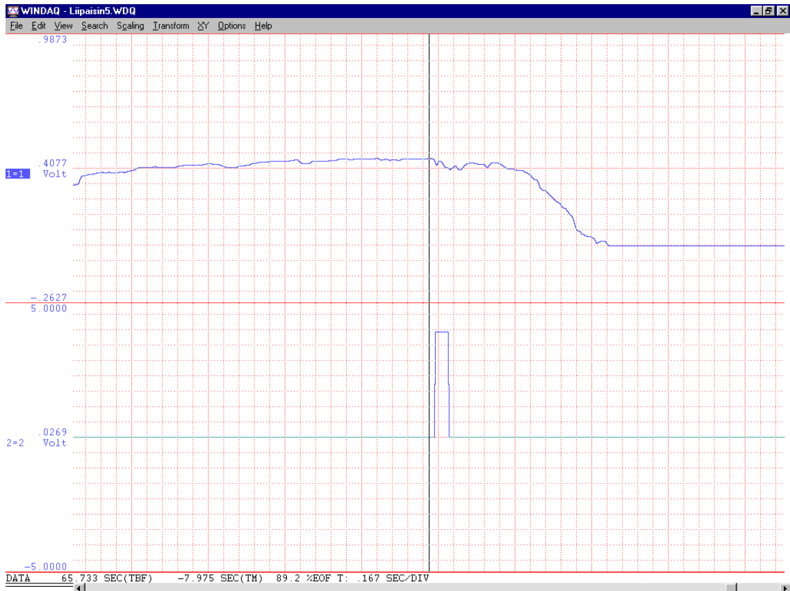
KUVA 26. Liipaisuprofiili keskeltä. Ylemmässä kanavassa näkyy liipaisuprofiili ja alemmassa liipaisukynnyksen ylittyminen profilissa (jännitepiikki).
