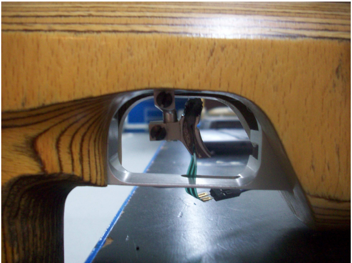
KUVA 20. Liipaisin 3 kivääriin kiinnitettynä
