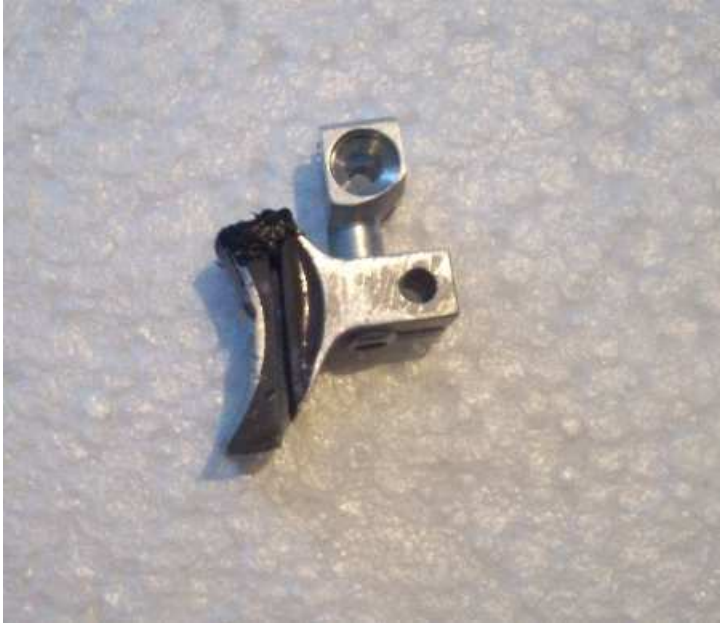
KUVA 14. Kahteen osaan halkaistu liipaisin
