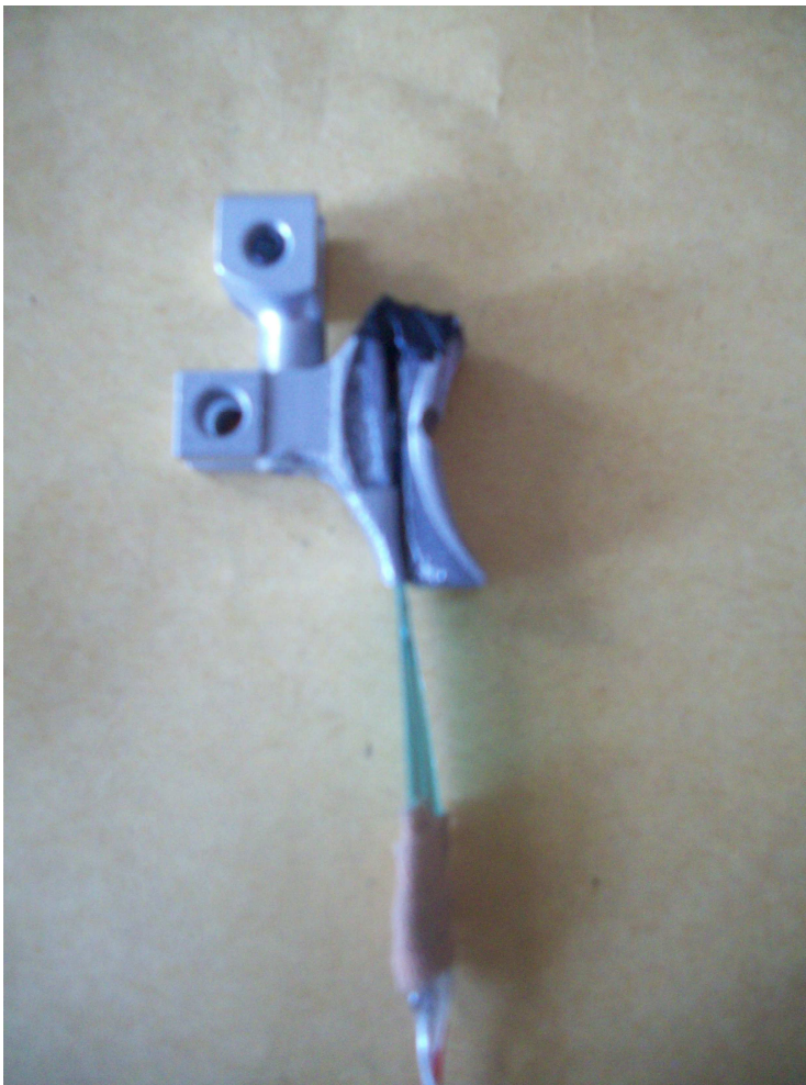
KUVA 15. Anturi kiinnitettyinä liipaisimeen
