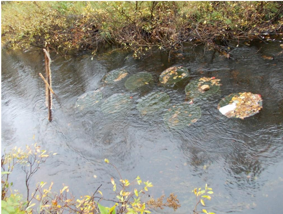
Kuva 1. Sumput B-purolla. Virtaussuuntaan nähden perimmäisenä on näytekalasumppu. Sumppujen eteen oli rakennettu suiste, jotta virran mukana kulkevat lehdet eivät tukkisi sumppuja (Kuva: Jouni Salonen).
