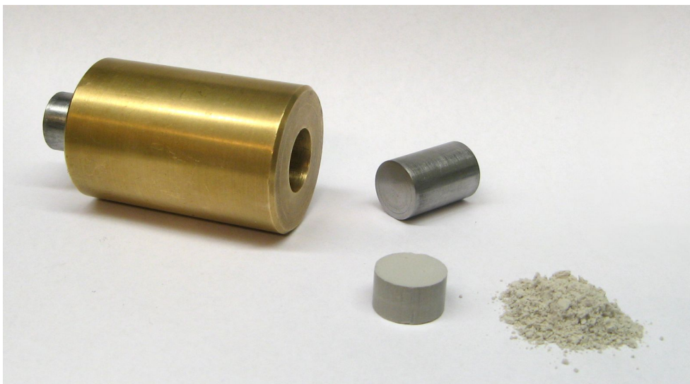
Kuva 5.1: Bentoniittinäytteiden valmistukseen käytetyt välineet, bentoniittijauhetta ja valmis näytenappi.
