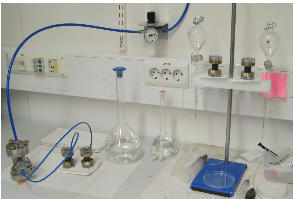
Kuva 5.4: Näytteiden kastelujärjestelyt. Vasemmalla alareunassa on kaksi näytettä kastelussa paineen alaisena. Paineilmalla saadaan tarvittava paine vesisäiliöön ja siitä näytteisiin (kuvassa p_0 \sim 8 bar). Oikealla yläreunassa on kaksi näytettä paineettomassa ( p_0 < 0,01 bar) kastelussa, missä erotussuppilot toimivat vesisäiliöinä.
