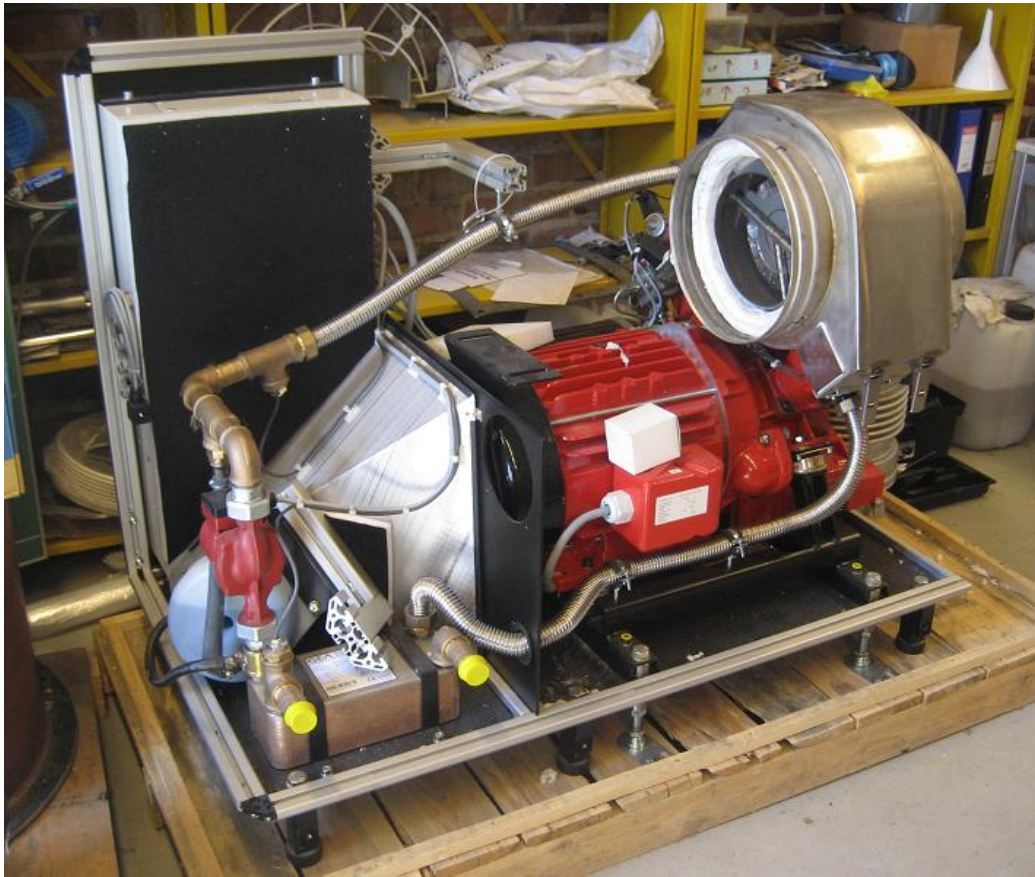
Kuva 3.5: Valokuva Jyväskylän yliopiston mikro-CHP-laitteistossa sähköntuotannosta vastaavasta Solo V161 -stirlingmoottorista laitteistoon vielä asentamattomana.
