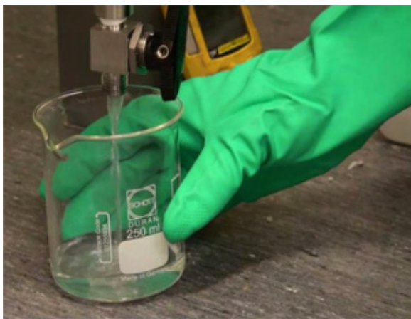
KUVA 6. Reaktorilaitteistolla tuotettua metanolia. Metanoli on tuotettu synteetikaasusta, joka on kaasutettu mustalipeästä.
