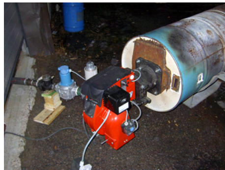
KUVA 4. Arvioitu kaasun tuotanto käytettäessä kaasupoltinta. Puukaasukäyttöinen kaasupoltin (vasemmalla) ja testauslaitteisto (oikealla).
