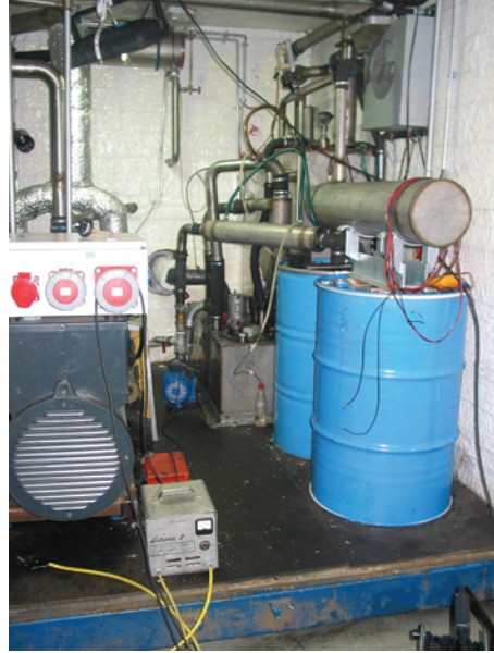
KUVA 1. CENTRIAn myötävirtakaasutin, joka perustuu patentoituun EK-kaasutusteknologiaan.
