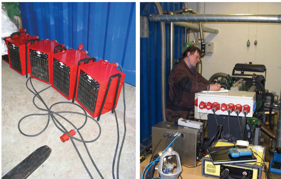
KUVA 3. Tutkimusta kaasun tuotannosta ja polttoaineen koostumuksesta modifioidulla 8-litraisella, 6-sylinterisellä IC-moottorilla. Käytetty sähkötehon kuormitin 9 kW (vasemmalla) ja IC-kaasumoottori (oikealla).
