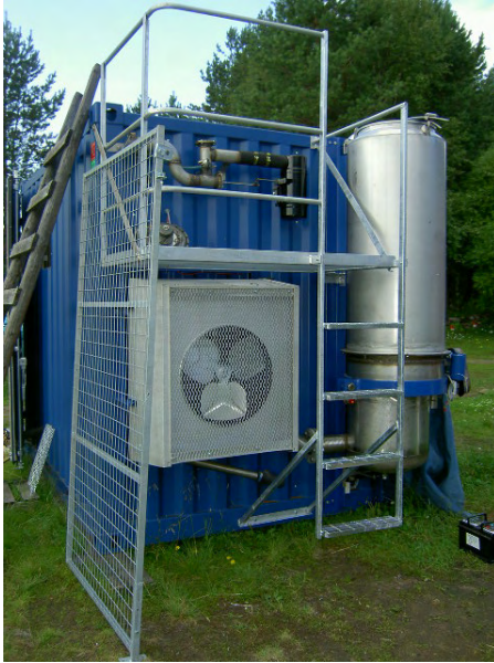
KUVA 1. CENTRIAn myötävirtakaasutin, joka perustuu patentoituun EK-kaasutusteknologiaan.
