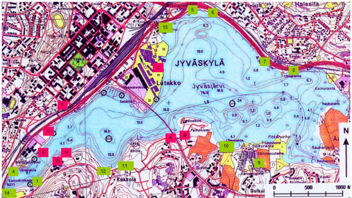
Kuva 1. Hulevesinäytteenottopisteet, Jyväsjärveen laskevat purot ja Tourujoki numeroituina (1-15) vihreällä pohjalla, sadevesikaivot ovat punaisella pohjalla kirjaimilla (A-H) (alkuperäinen kuva: Keränen 2001).
