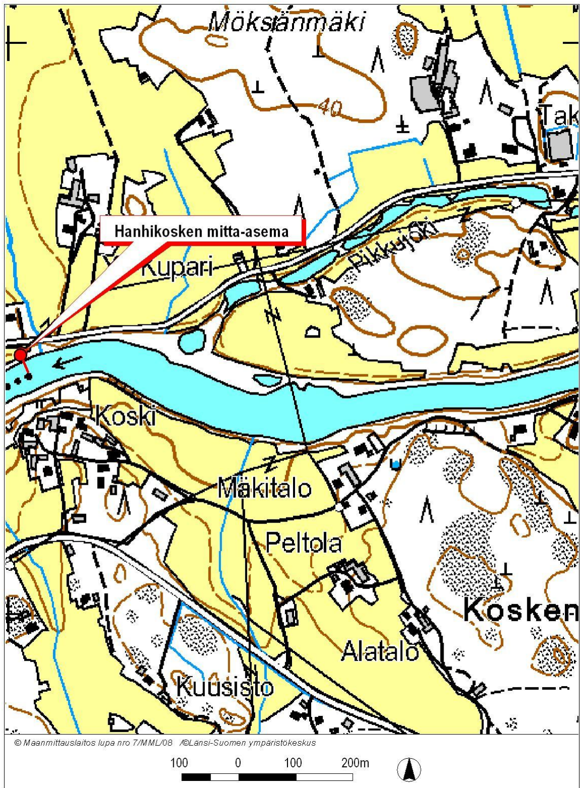
LIITE 21: Hanhikosken automaattisen mitta-aseman ja sen vedenottoputken sijoittuminen.
