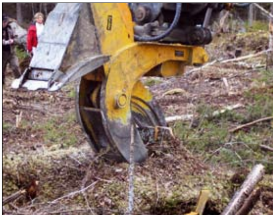
Kantojen korjuun tekniikka on kehittymässä siistimpään suuntaan. Nykyaikainen kauha nostaa kannon useassa osassa ympäröivää maanpintaa pahemmin turmelematta. Kuva UPM-Kymmenen työnäytöksestä. Kuva: Jari Haimi
